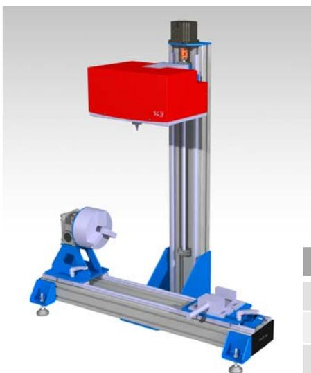
Маркиратор, оснащенный поворотной осью D, позволяет маркировать наружные поверхности цилиндрических деталей. Деталь может фиксироваться по наружному и внутреннему диаметру. Максимальный диаметр детали в месте фиксирующего зажима не должен превышать 145мм при внешней и 160 при внутренней фиксации.
